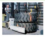
两用叉夹可灵活使用、既可用于货物的夹持搬运也可用于对托盘进行叉持搬运。两用叉夹可 直接对轮胎进行夹持,也可灵活根据需要将夹臂旋转到水平位置对置于托盘上的轮胎堆垛进 行叉持。两用叉夹的承载能力最大可达3200kg。
